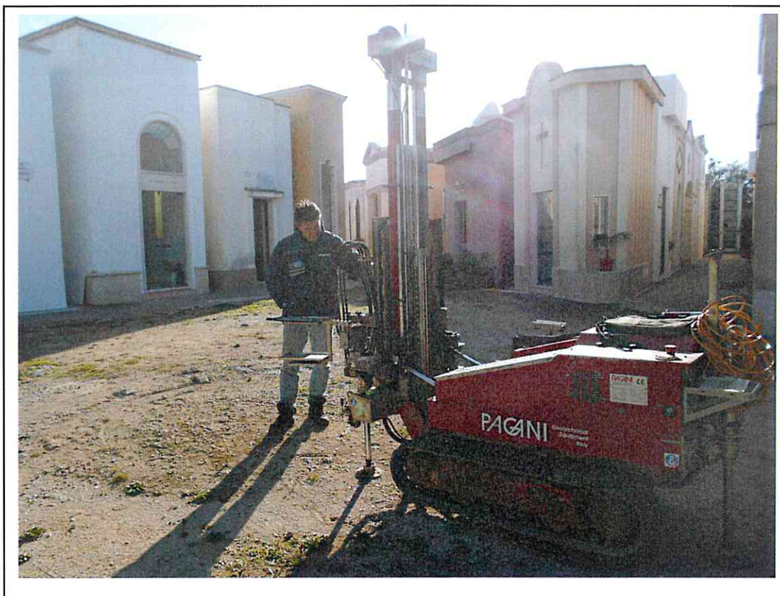
Esecuzione prova penetrometrica n. 2
