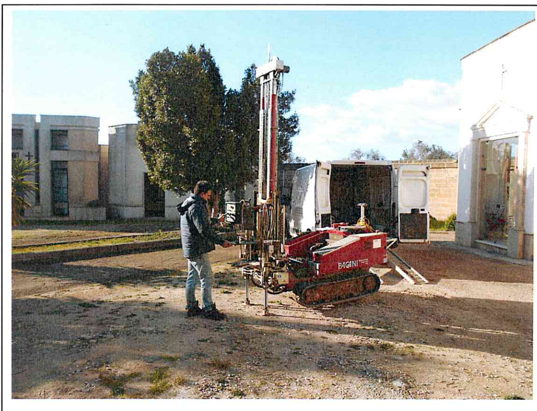
Esecuzione prova penetrometrica n. 1
